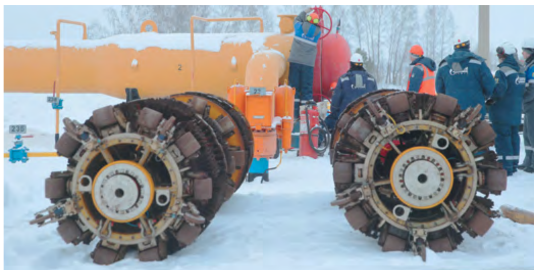
Очистное устройство и внутритрубный инспекционный диагностический снаряд – это просто «поршень»
